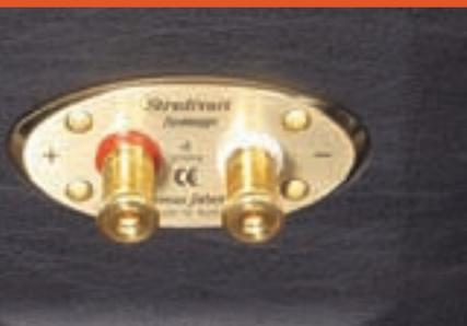
Und wenn die Welt voll Bi-Wiring-Terminals wär': Bei Sonus Faber hält man nichts von doppelter Kabelzufuhr. Die Italiener vertrauen den eigenen (sehr guten) Schraub/Steck-Anschlüssen und einer Weichen-Architektur mit Leiterbahnen aus Platin-Legierung. Die Tieftöner werden bei Seas gefertigt, mit extra langem Hub.
