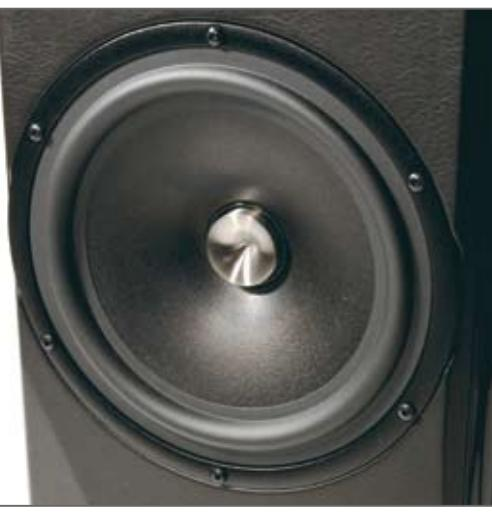
高音是 29mm 超大動態及線性的 Ragnar Lian 動圈式單元；中音亦是超大動態及線性，無渦流音圈的 CCAW/Kapton 179 mm 紙盤單元；低音則是雙 220 mm，鋁鎂合金音盤。
