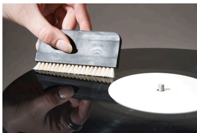
Foto 3: distribuzione del liquido di pulizia
